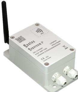
Der Funk-Puls-Konverter Supercom P ist ein kombinierter Konverter zur Fernauslesung aller Arten von Verbrauchsgeräten mit digitalem Impulsausgang. Er verfügt zudem über einen drahtgebundenen M-Bus Master mit dem bis zu zwei Slaves angeschlossen werden können. Der Supercom P speichert die Verbrauchswerte und überträgt die Daten über das LoRaWAN®-Netzwerk. Der Puls-Funk-Konverter ist programmierbar, so können Rücklauf und/oder Manipulationserkennung eingestellt werden.
