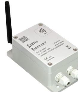
Il convertitore impulsi-radio Supercom P è un convertitore combinato per la lettura a distanza di tutti i tipi di dispositivi di consumo con uscita digitale a impulsi. Ha anche un master M-Bus cablato con cui si possono collegare fino a due dispositivi slave. Il Supercom P registra i valori di consumo e trasmette i dati attraverso la rete LoRaWAN®. Il convertitore di impulsi radio è programmabile, quindi è possibile regolare il riflusso e/o il rilevamento della manipolazione.
