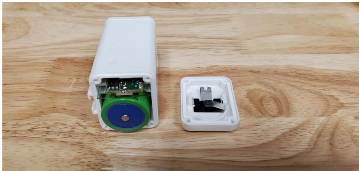
Abbildung 2-9: Markierungen für die Batteriepolarität und Einlegen der Batterie
