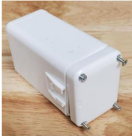
Abbildung 2-8: Entfernen der Schrauben der Batterieabdeckung
