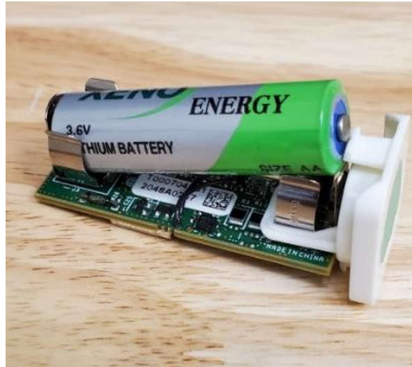
Abbildung 2-6: Ausrichtung der Batteriepolartät
