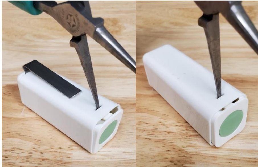
Abbildung 2-5: Entriegeln der Endkappe mit einem Werkzeug
