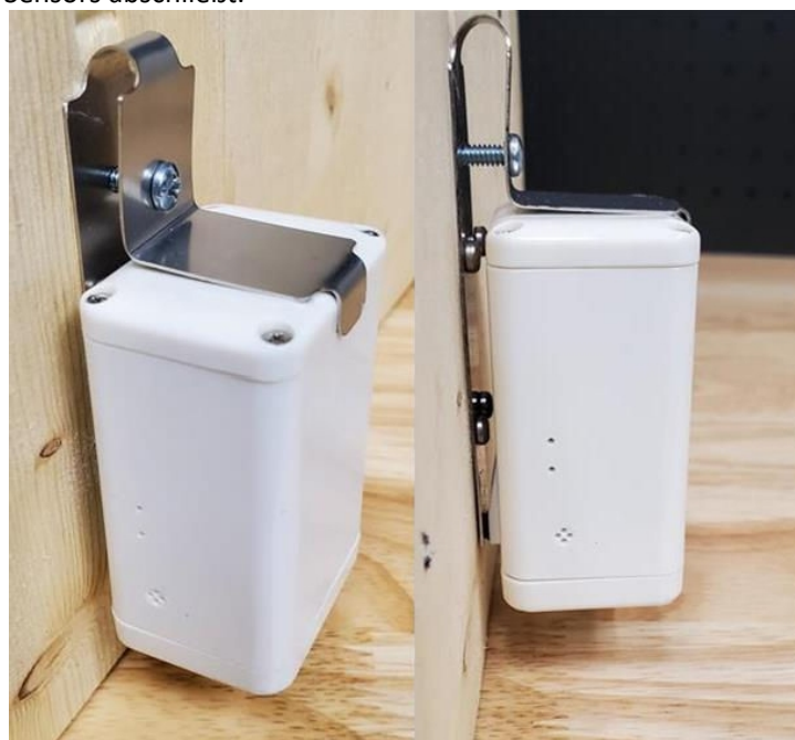
Abbildung 2-4: Befestigen des Sensors in der Halterung mit einer fünften Schraube
