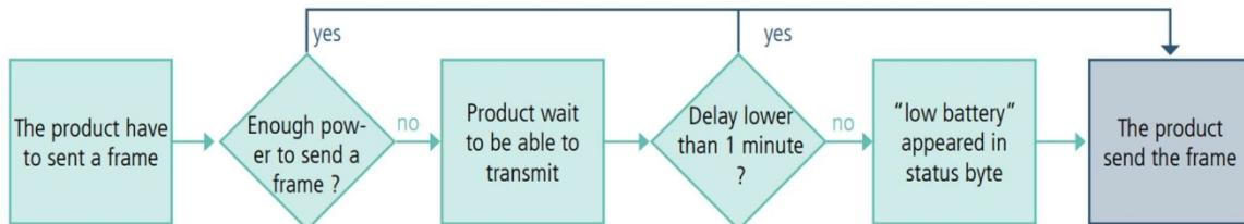
Das Flag „Batterie schwach“ verschwindet automatisch, wenn die Batterie ausgetauscht wird oder wenn die Temperaturbedingungen für die ordnungsgemäße Funktion der Batterie günstig sind.
