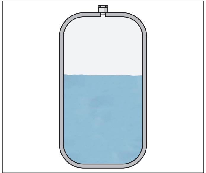
Abb. 14: Füllstandmessung mit VEGAPULS Air 41 im Flüssigkeitstank
