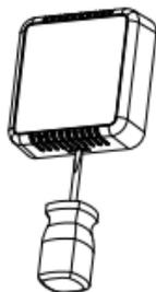
Il faut dégrafer le capot du socle avec un tournevis pour vis à fente
